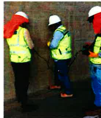
Equipo Ultrasonido con Transductor de 54 kHz Marca: PROCEQ Modelo: Pundit PL-200
