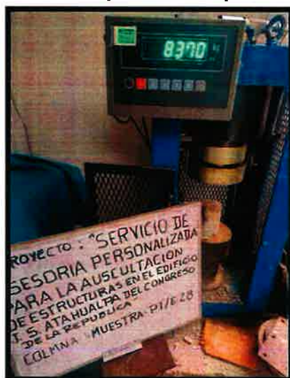
Figura N° 03: Prensa de Compresión Simple de Testigo de Concreto
