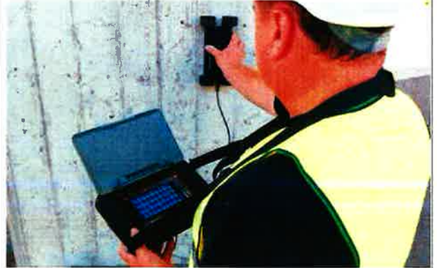
Medidor de Cobertura, Diámetro y Detector de Barras Marca: PROCEQ Modelo: Profometer 630
