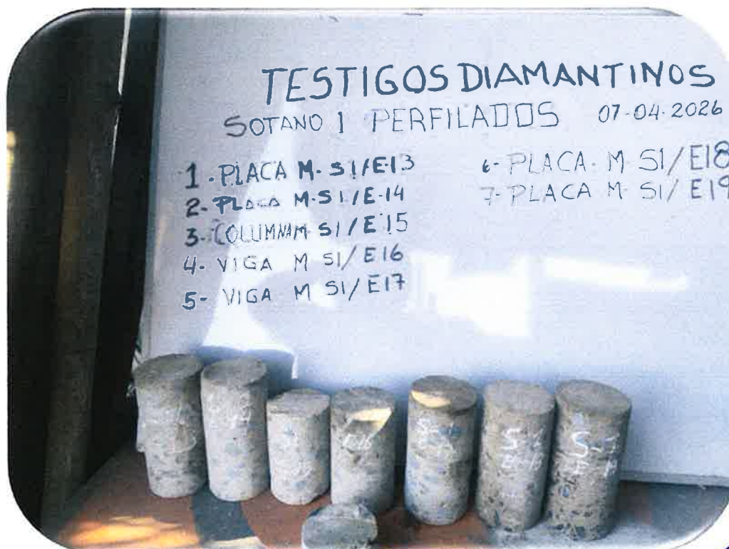
TESTIGOS DIAMANTINOS PERFILADOS
