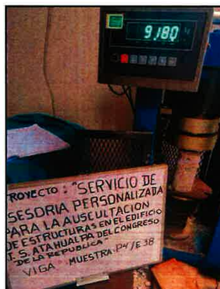
Foto N° 19: Ensayo Compresión Simple de Testigo P4-E38
