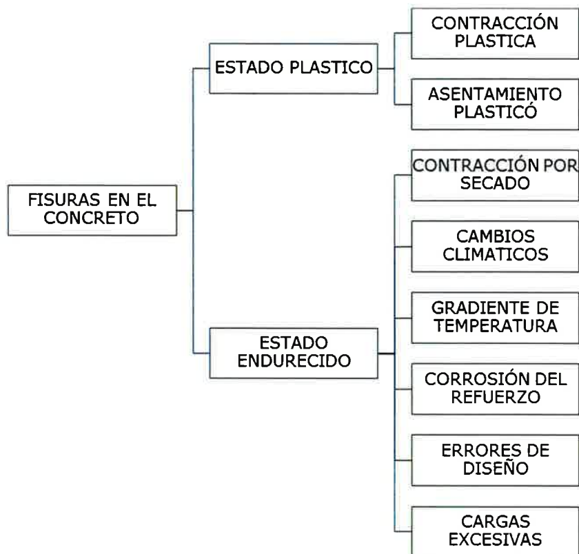
Figura: Causas de fisuración del concreto
