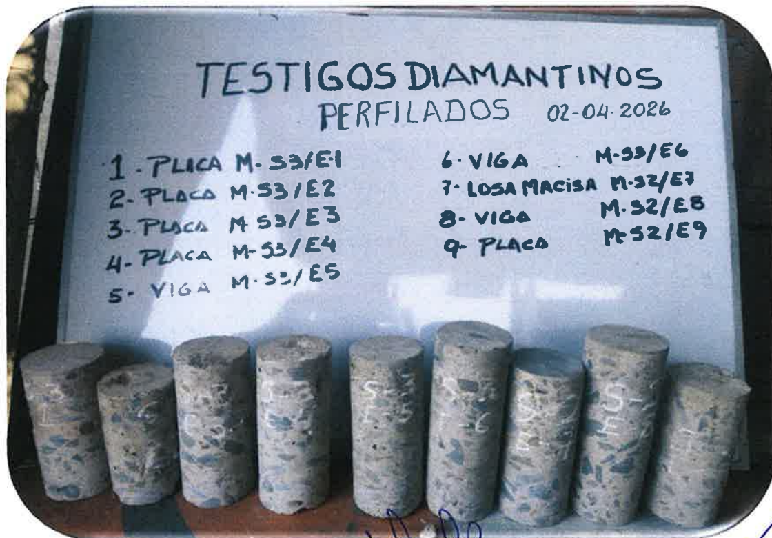
TESTIGOS DIAMANTINOS PERFILADOS
