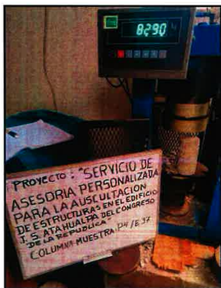
Foto N° 18: Ensayo Compresión Simple de Testigo P4-E37
