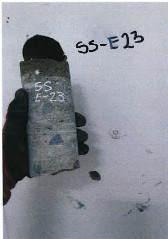
PERFORACIÓN EN VIGA SS E23
