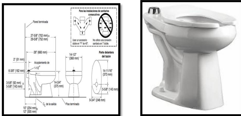
Imagen referencial de sanitario para instalar fluxómetro
