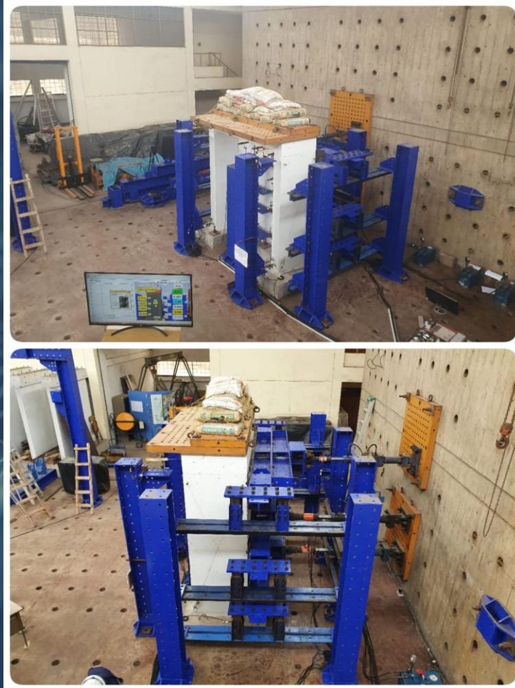
Ensayo de carga de Tsunami
