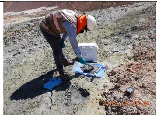
**Fotografía 12.** (Fotografía DSCN8391): Vista de la toma de muestra de suelo del ESP-SU-8 en la superficie del depósito de relaves.
