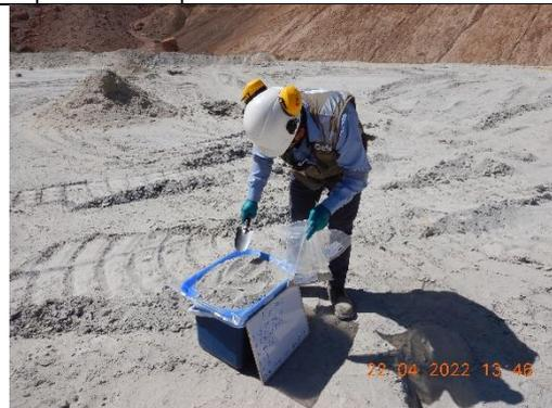
**Fotografía 13.** (Fotografía DSCN8269): Vista de la toma de muestra de suelo del ESP-SU-1 en la superficie del depósito de relaves de flotación.
