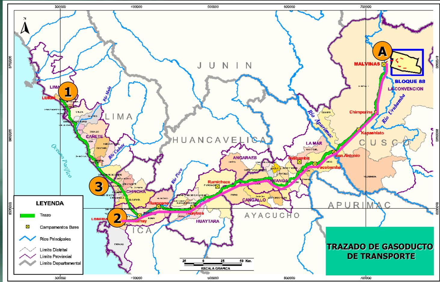
Tubería de Gas C1 y C2 desde **A** hasta **1**
