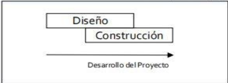
Esquema 1. Traslape Diseño – Construcción en Fast – Track para un paquete de trabajo
