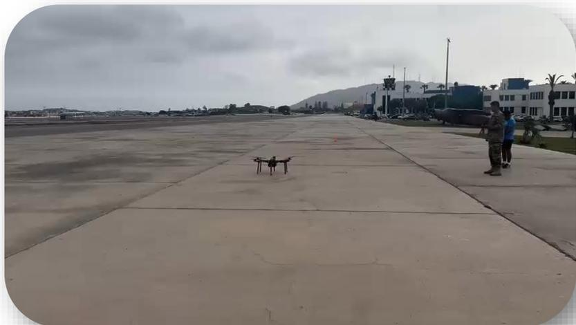
Sistema RPAS modelo hexacopter, capaz de cargar hasta 5kg de peso, con autonomía de hasta 1 hora 45 min, con capacidad de llevar diversos sensores como cámaras infrarrojas, cámaras de alta precisión, cámaras LiDAR, (detección y localización por luz), entre otras, puede ser utilizado en modo manual y automático
