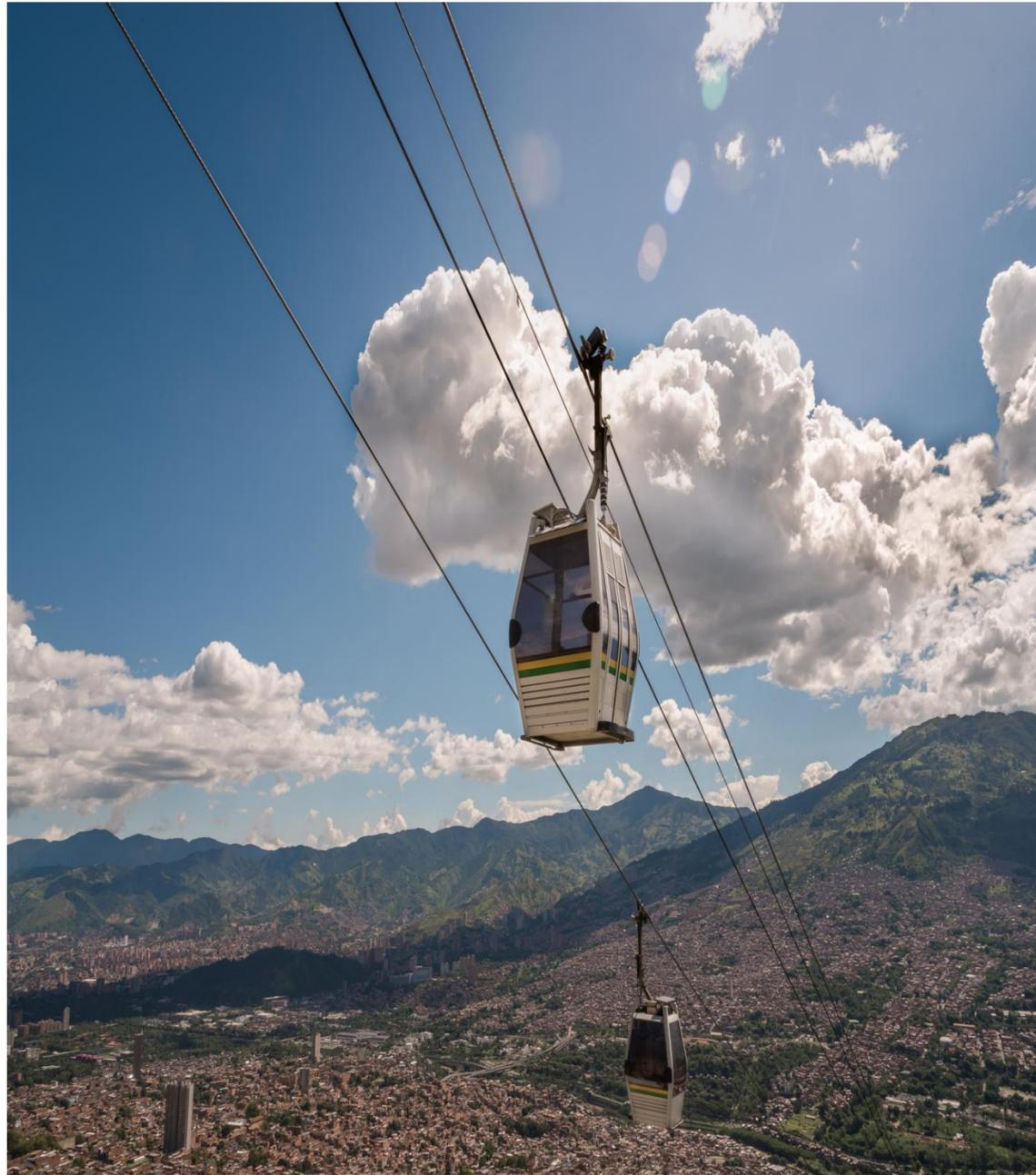
El teleférico es un medio de transporte de personas en cabinas suspendidas en el aire de un punto a otro a través de uno o varios cables. Son accionados por energía eléctrica. Este transporte se usa en zonas con grandes diferencias de altura, donde el acceso por carretera es muy accidentado o inaccesible.
