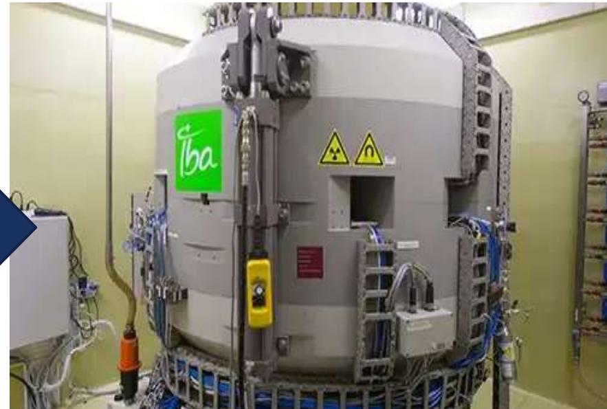
CICLOTRON para la producción de un radiofármacos marcados con los radioisótopos
