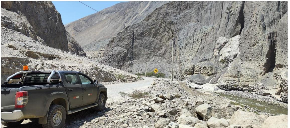
**Foto Nº 03.-** Alternativa Alta de la Captación Chuquicara en el río Santa; aguas arriba de la confluencia con el río Tablachaca. Ambos flancos con acumulaciones y terrazas aluvionales con taludes superiores a 40 grados. En el cauce se observa un alto porcentaje de bolonería y bloques derivados mayormente de rocas intrusivas (tamaños superiores a 0.50m).
