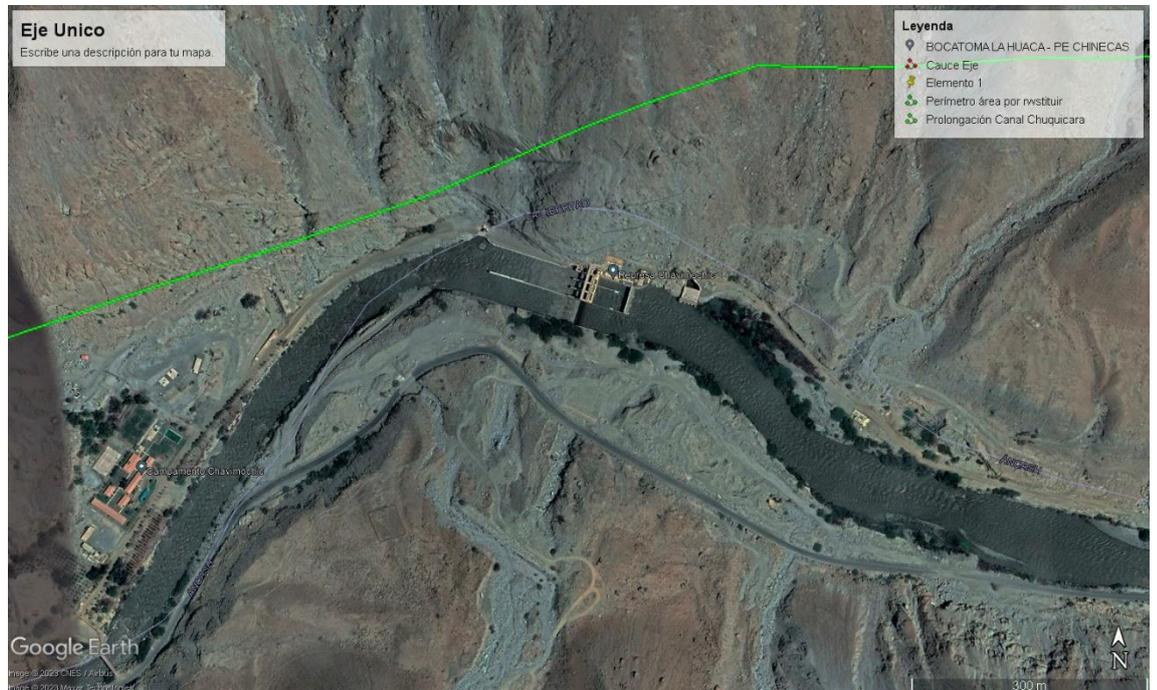
**Imagen Satelital N° 01.-** Captación Única, en la Bocatoma Chavimochic; se requiere una evaluación Geológica y Geodinámica de la margen izquierda por la presencia de la Quebrada Sin Nombre, que descarga próxima a la obra existente.
