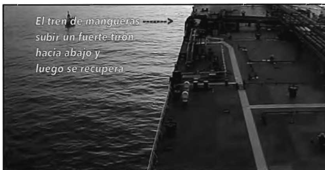
Figura 14. Tensión de la manguera de descarga
