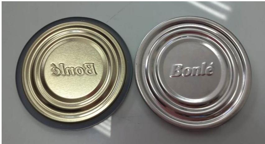
Foto 3: Vista del compuesto sellador en tapa
