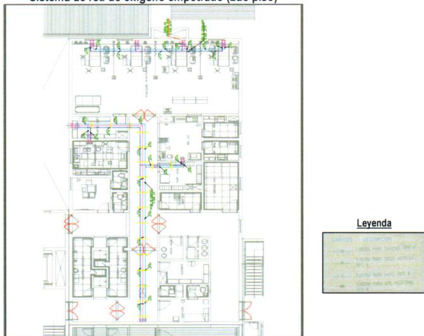
Imagen n.º 02: Sistema de red de oxígeno empotrado (2do piso)
