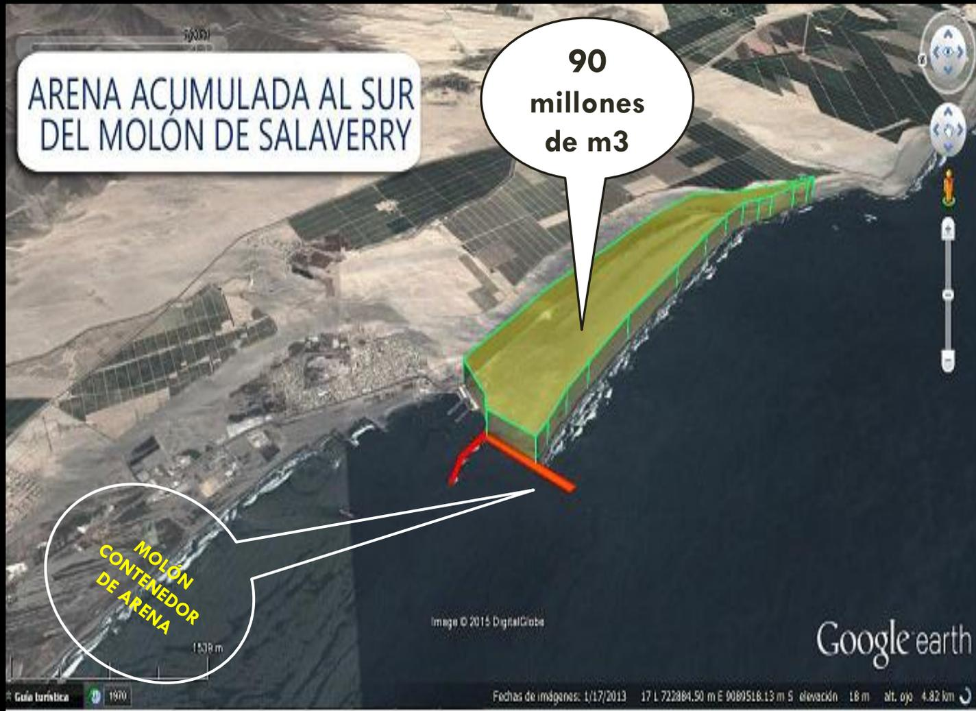
La principal, causa de la erosión de la costa de Trujillo, es la construcción y ampliación sistemática del molón contenedor de arena del Puerto de Salaverry que tiene cautivo más de 90 millones de m<sup>3</sup> de arena al sur.
